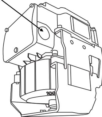
图 5 敲落孔
